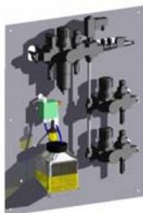
El panel de medios controla los sistemas de aire y lubricación del T2X.
