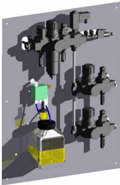
*Panel de medios con unidad de aire principal y sistema de lubricación.*
