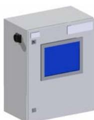
Esta unidad recibe la alimentación de corriente entrante de 400VAC/ 25A y distribuye toda las 230VAC, 24VDC y seguridad entrelazada 24VDC. El AE1 está directamente conectado a la bomba y a la estación de base. Esta caja incluye los relés de seguridad para paradas de emergencia y seguridad y sirve de unidad de distribución dentro del sistema T2X.
